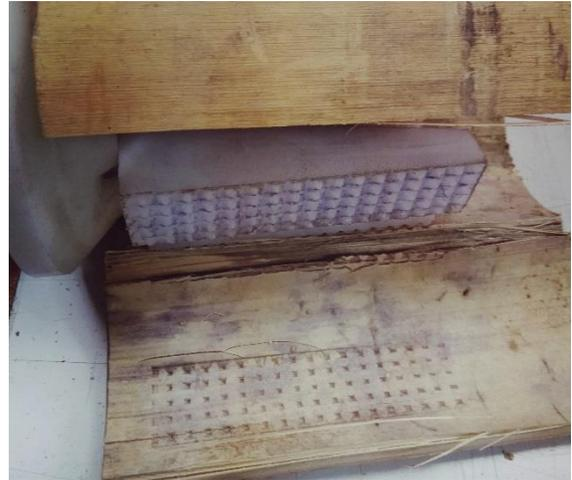
Figura 24: incrustaciones en el interior del bambú después del ensayo a tracción.
