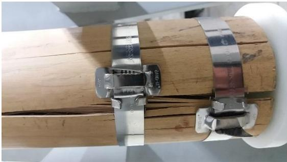
Figura. 23: Rotura final: fisuras múltiples del bambú y apertura del zuncho en la zona de la grampa (carga  $\geq 1000\text{kg}$ )
