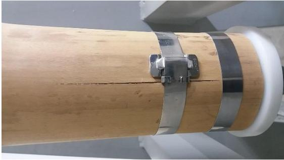
Figura 22: Primera falla: fisura en el lugar de la grampa del zuncho (carga  $\geq 650\text{kg}$ )
